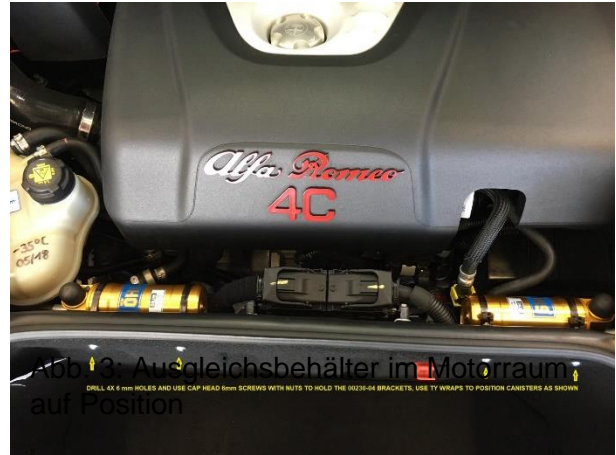
Abb. 3: Ausgleichsbehälter in Position
